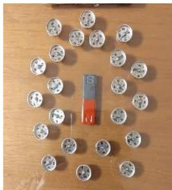
図 27 棒磁石と方位磁針の実験結果 Ver.2
