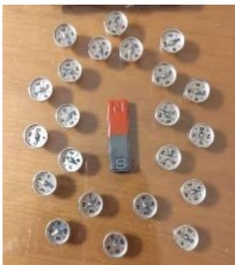
図 26 棒磁石と方位磁針の実験結果 Ver.1
