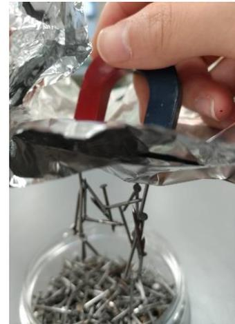
図6 鉄以外を挟んだ磁石の反応結果
