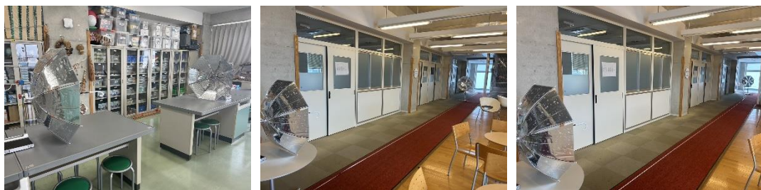
図17 2本の傘の距離を変えて実験する様子 (左：2.5 m、真ん中：10 m、右：15 m)
