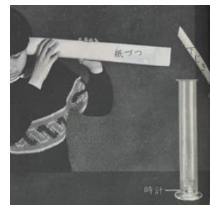
図 5 音の反射の実験方法
