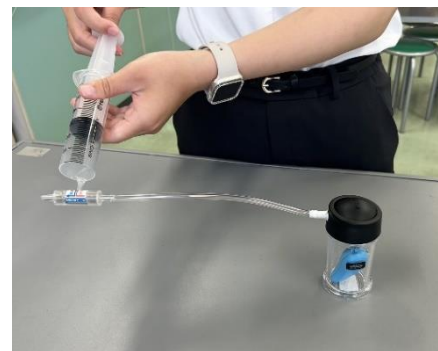
図9 醤油差しの中を真空にする様子
