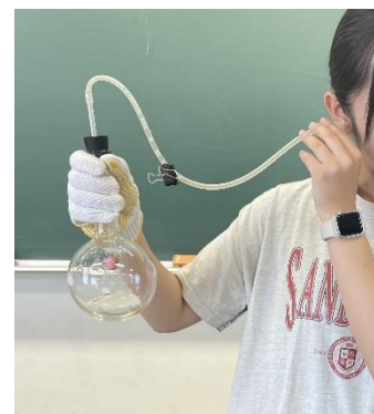
図 8 フラスコ内を真空にした後音を聞く様子
