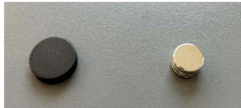
図16. フェライト磁石(左)とネオジム磁石(右)
