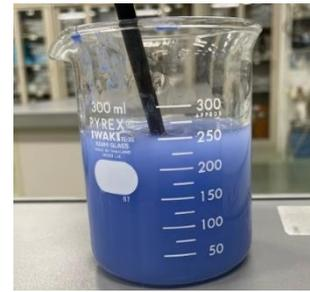
図 16. 示温インクを混ぜたアルギン酸ナトリウム
