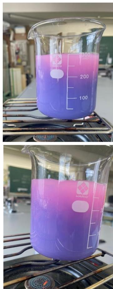
図3. サーモインクによる対流実験
