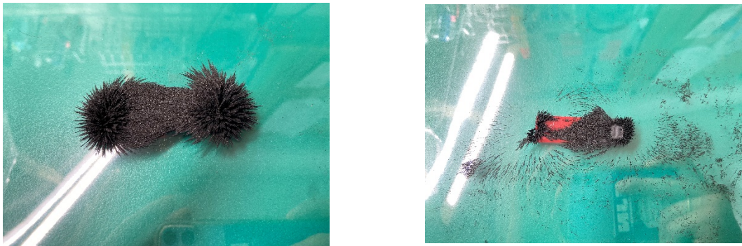
図 1 2 砂鉄の量が多く磁力の向きが見えにくい様子と砂鉄の量を減らし、見やすくなった様子
