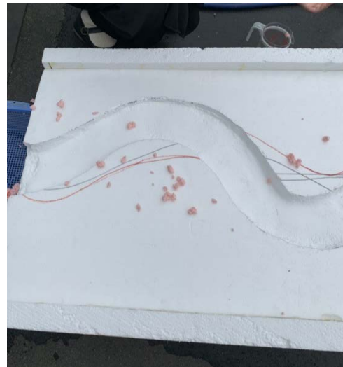
図 1 0 . 溢れたフォームポリスチレン
