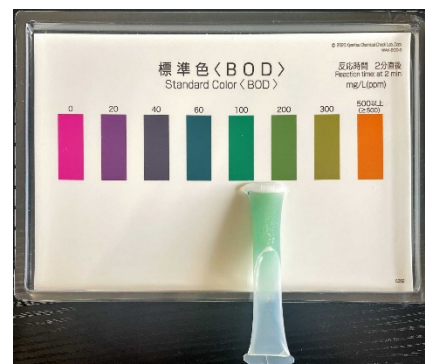
図 44. 水 200 ml にマヨネーズ 2.5cc を入れた場合のパック テスト (BOD) の結果
