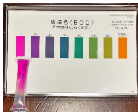
図 26. 水 500 ml に未使用油 1.25 ml を入れた場合のパック テスト (BOD) の結果
