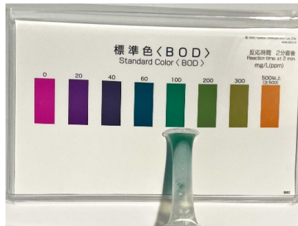
図 40. 水 100 ml にシャンプー 2.5 ml を入れた場合のパック テスト (BOD) の結果
