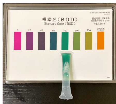
図 54. 水 200 ml に無色シャンプー 10cc を入れた場合のパックテスト (BOD) の結果
