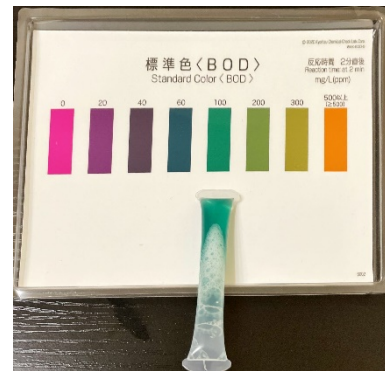
図 50. 水 200 ml にシャンプー 2.5cc を入れた場合の パックテスト (BOD) の結果
