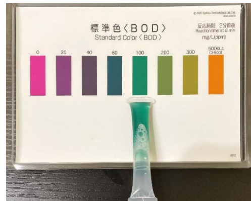
図 52. 水 200 ml に無色シャンプー 5cc を 入れた場合のパックテスト (BOD) の結果
