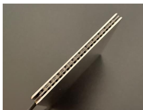
図 20.ペルチェ素子の断面
