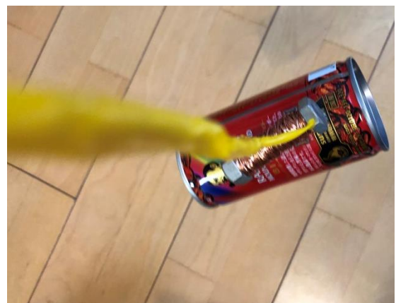
図 58. 鉄拾い機を使ってスチール缶を持ち上げている様子
