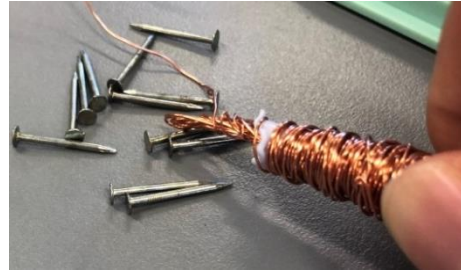
図 34. エナメル線のたばを鉄心にする実験
