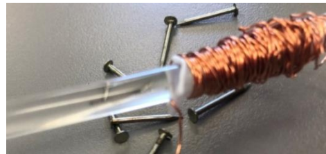
図 36. ガラス棒を鉄心にする実験
