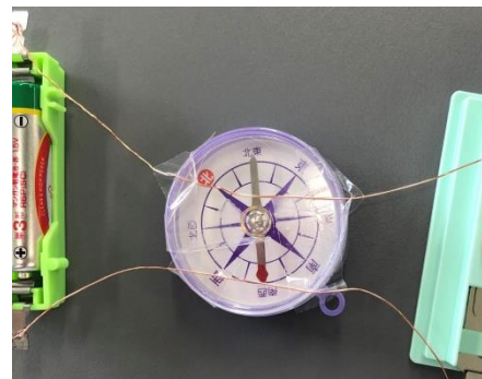
図 19. エナメル線を磁針に平行にした実験
