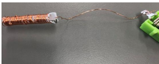
図 15. もくねじを鉄心にして磁力を調べる。
