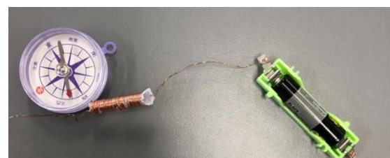
図 16. 鉄心に何も入れずに磁力を調べる。
