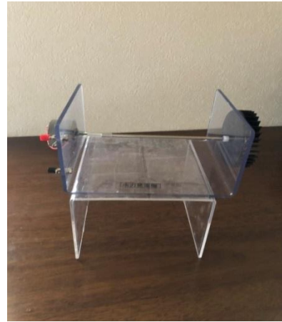
図 54. 固定した水力発電機と土台
