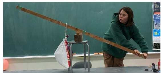
図 3 作用点を動かし、手ごたえを感じる実験の追試
