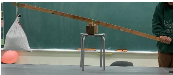
図 3 作用点を動かし、手ごたえを感じる実験の追試
