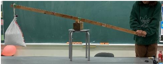
図 2 作用点を変え、おもりの手ごたえを感じる実験の追試
