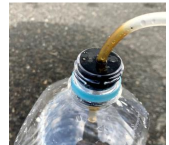
図 19. 取り外せなくなった ゴムチューブ
