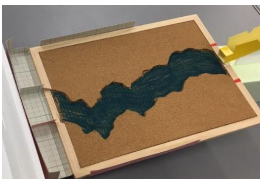
写真（24）工作用紙で制作した河川モデルの横壁と受け皿
