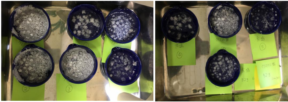
写真⑳ クリスタル塩水と食塩水を交互に並べた蒸発 1 日後
