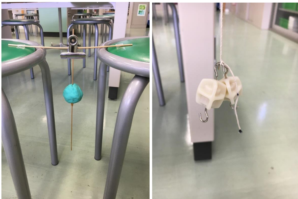
図 9. テンポ振り子と 20g のおもりの取り付け部分
