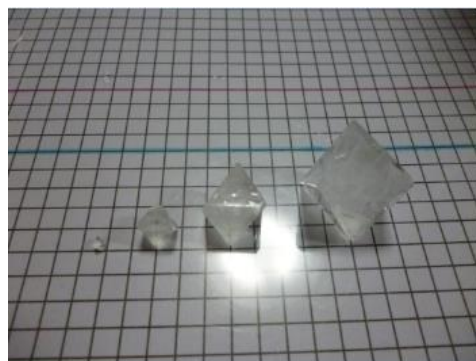
図 12 20 日目の結晶との比較 (左から開始前、7 日目、 13 日目、20 日目)
